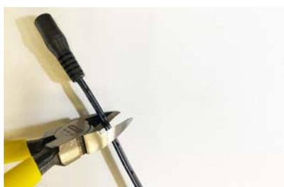
将滤波器DC插头剪断
