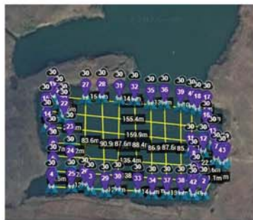
搭载TOSLON自动驾驶系统Xpilot 1000pro;利用Google earth 自动规划行驶轨迹。
