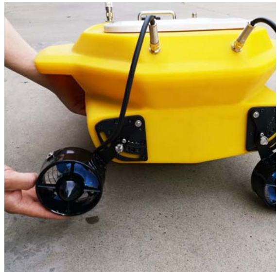
② 将推进器调整到一定角度。 然后拧紧螺丝。
