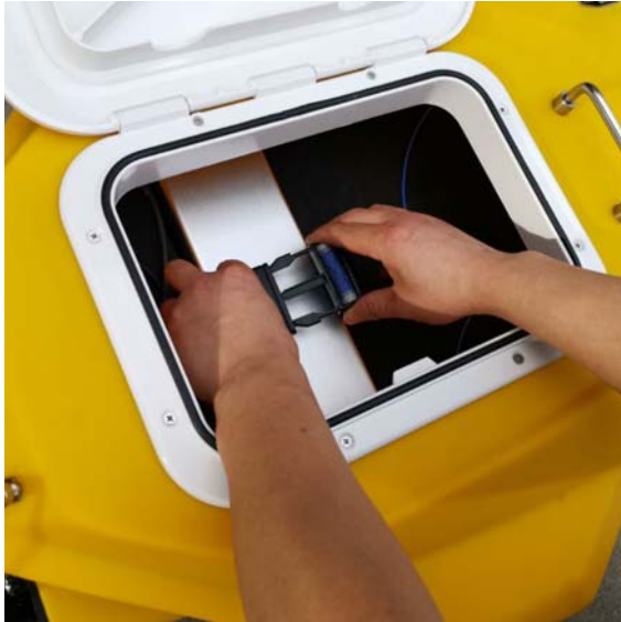
① 将电源固定在船舱内
