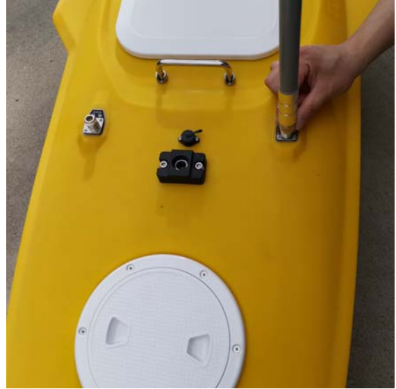
⑥ 将天线安装在船上
