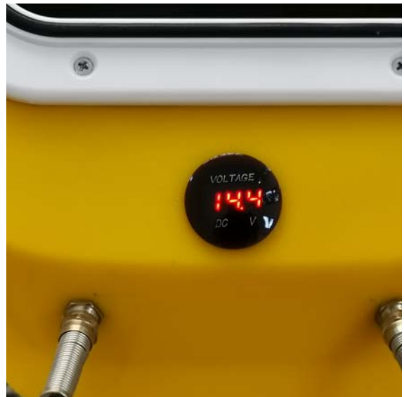
④ 连接电源。船尾的电量显示器上会显示当前电压值
