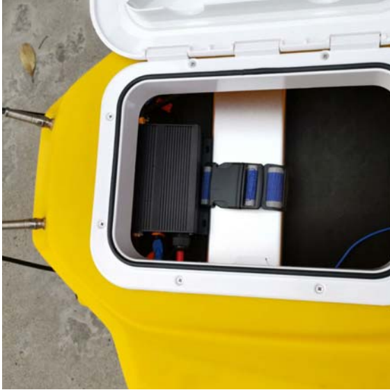
⑤ 将电调固定在船舱内
